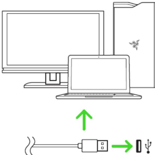
Крок 1. Переконайтесь, що пристрій Razer під'єднано до USB-порту комп'ютера.
